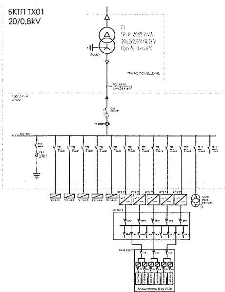
Списък с основното оборудване на 1MW/2MWh система за съхранение на енергия:
