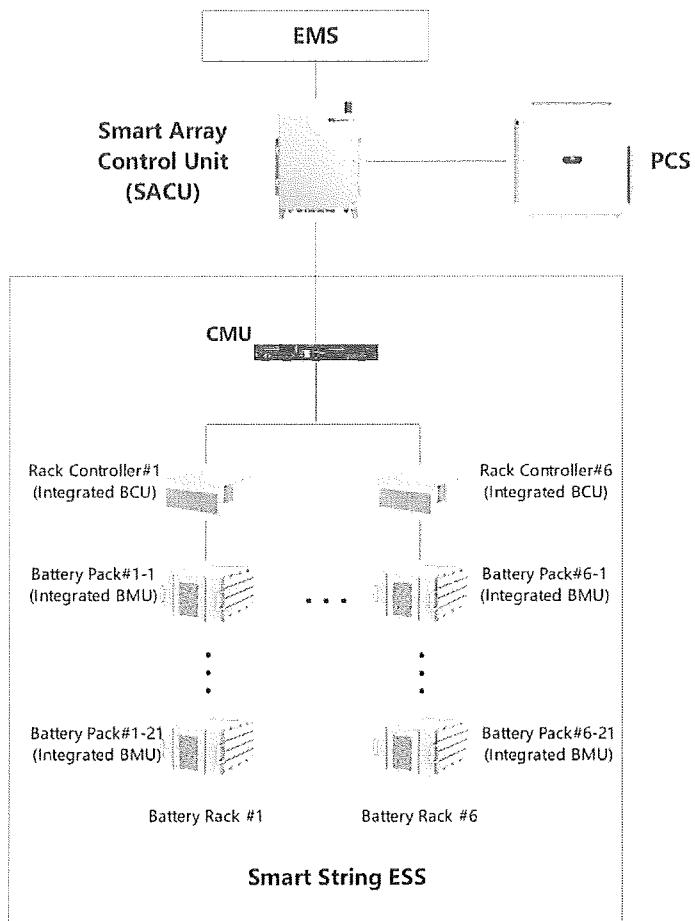
**BMU:** Блок за наблюдение на батерията, който следи и събира информация за работата на батерията, управлява пасивното електрохимично балансиране на клетките, диагностицира грешки и заобикаля батерията с помощта на оптимизатора на батерията.
