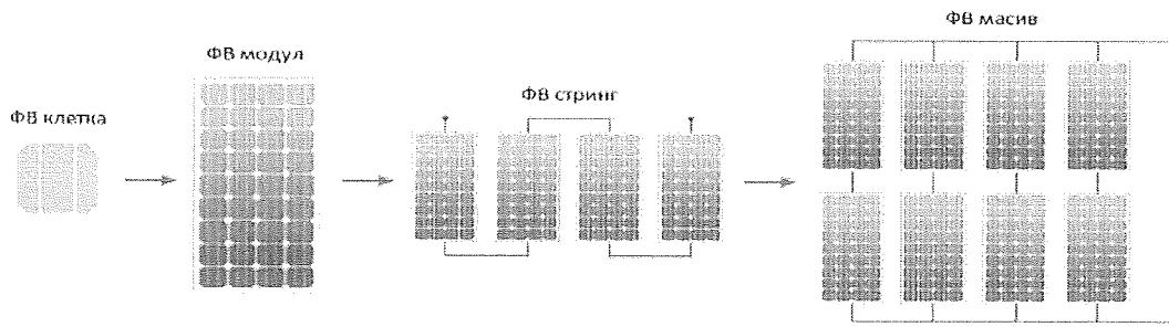
Фотоволтаичните модули преобразуват слънчевата радиация в постояннотокова (DC) електрическа енергия. За да може тази енергия да бъде отдадена и оползотворена в публичната електроразпределителна мрежа (ЕРМ), тя се преобразува в променливо токова (AC), с параметри съвместими с параметрите на ЕРМ и захранваните от нея консуматори. Преобразуването на електрическата енергия от DC към AC се извършва ефективно от статични електронни системи, наречени ФВ инвертори.
