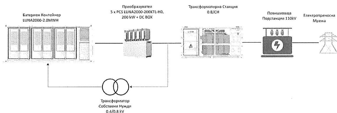
Архитектурата на две нива на решението за съхранение на енергия Huawei smart string позволява гъвкаво разгръщане на подмасиви въз основа на изискванията за продължителност на резервно захранване с променлив ток и постоянен ток.
